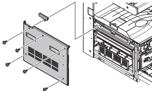
**19. Afloje los tornillos y retire la cubierta.**
