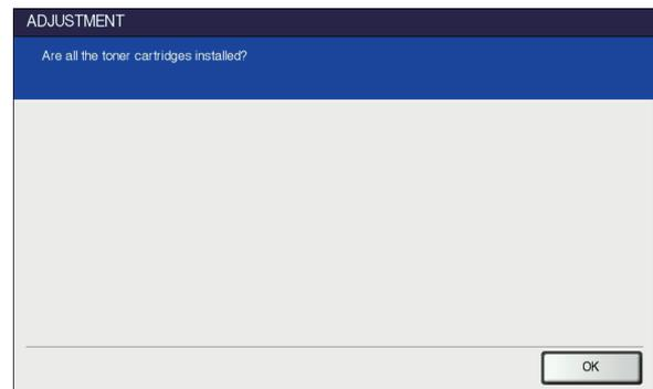
6. **Se lleva a cabo el ajuste del control de calidad de la imagen.** Durante la calibración, aparecerá la pantalla mostrada en la figura. Cuando se completa el ajuste del control de calidad de la imagen, comienza el ajuste de registro de colores.
