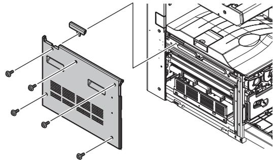
**19. Lösen Sie die Schrauben, nehmen Sie die Abdeckung ab.**
