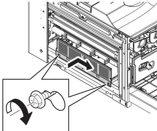
**22. Fixieren Sie die Abdeckung mit den Schrauben.**
