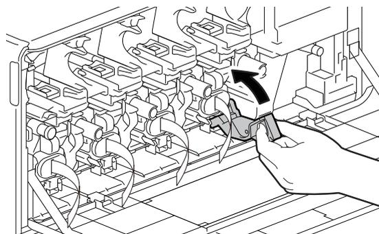
10) Drehen, anschließend Hebel anheben.
