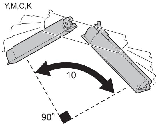
2) Drehen Sie die Tonerpatrone wie in der Abbildung gezeigt, ziehen Sie den Dichtungsstreifen ab.
