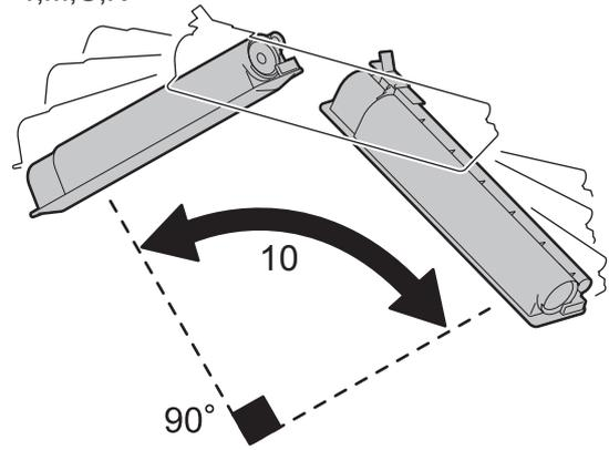
2) イラストの向きにして、シールを引き抜きます。
