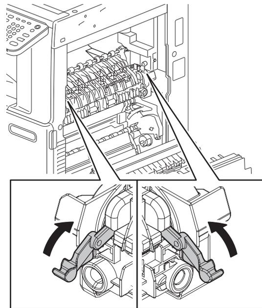
**9. Entfernen und entsorgen Sie die Schutzelemente [J].**
