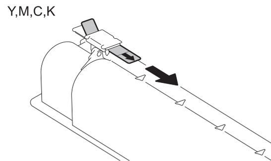
3) Instale el cartucho de t3ner del color correspondiente en la unidad de revelado.
