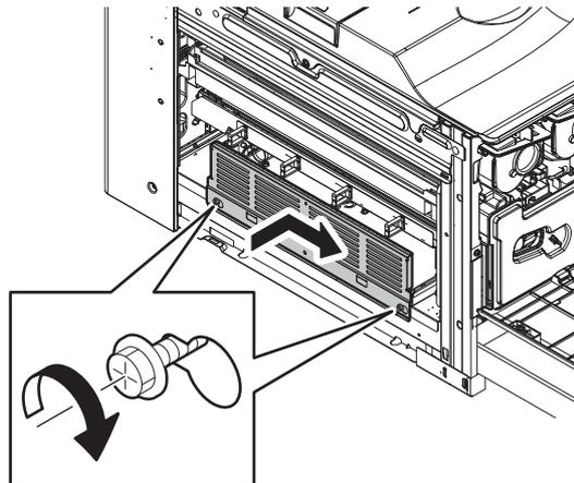
**22. Fije la cubierta con los tornillos.**
