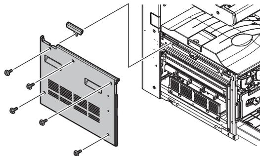
**19. ネジをゆるめて、カバーを取り外します。**
