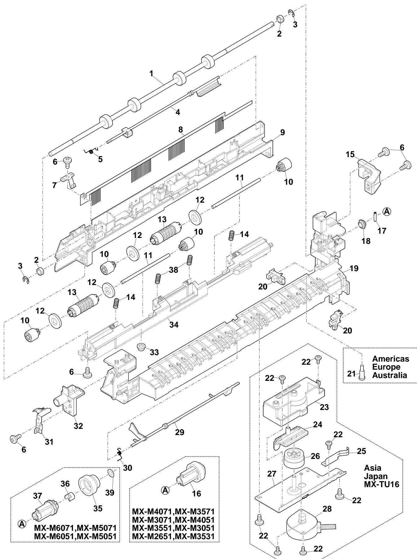
定着後ろ<sup>°</sup>-バー<sup>°</sup>-ガ<sup>°</sup>イド<sup>°</sup>ユニット (Fusing rear paper guide unit)
