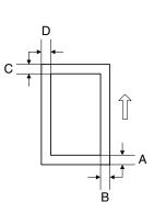
A: Trailing edge blank margin B: Right edge blank margin C: Leading edge blank margin
