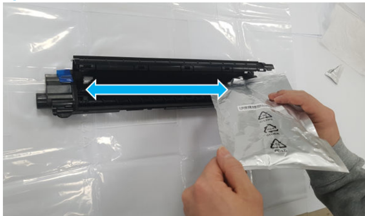
Figure 2-75 Pour the carrier
