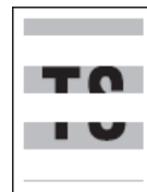
Hueco en la impresión por la condensación (Hollow print by condensation)
